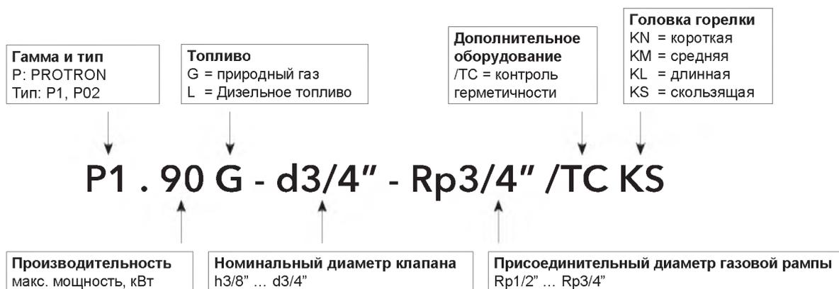
МОНОБЛОЧНЫЕ ГОРЕЛКИ HO-TRON И GHO-TRON
