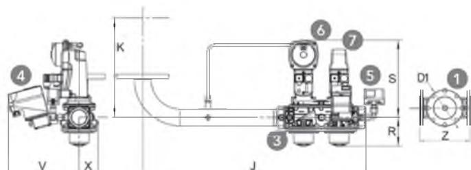
Газовая рампа полностью установлена, имеет все электрические подключения и протестирована (электрически, гидравлически и на герметичность)
